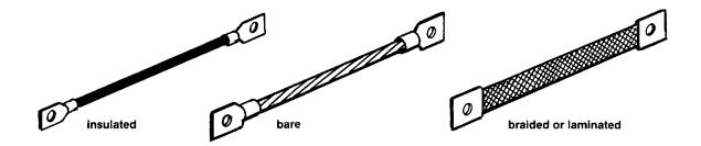
Figure 4.62 BONDING JUMPERS
