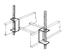
Figure 4.2A SINGLE CABLE TRAY HANGER
