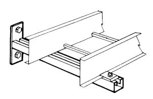
Figure 4.7A SINGLE STRUT CANTILEVER BRACKET
