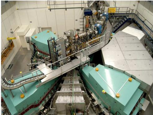
(b) 72 MeV Injector Cyclotron.
